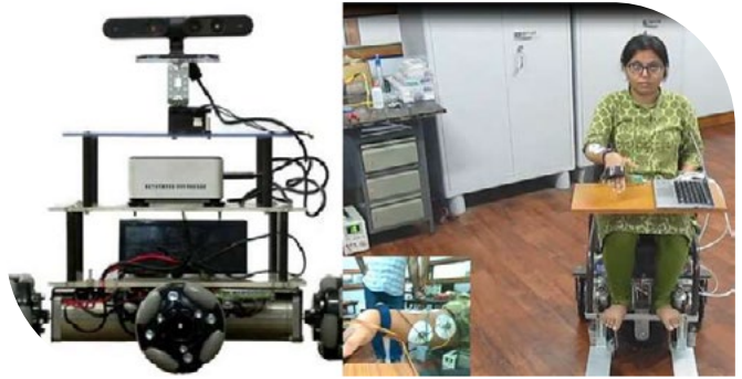
गतिशील वातावरण में नेविगेशन के लिए मल्टीमॉडल इंटेलिजेंट व्हीलचेयर आधारित ट्रांसपोर्टर
