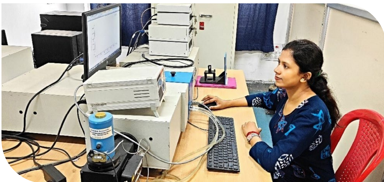
फ्लोरोलॉग (निर्माता: HORIBA), स्थिर अवस्था और उत्तेजित अवस्था स्पेक्ट्रोस्कोपिक अध्ययन
